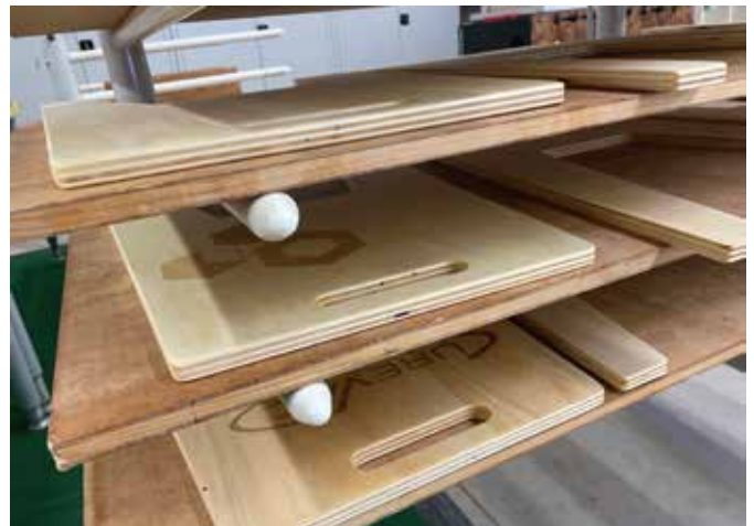
Die bereits montierten und geschliffenen Einzelteile haben eine Lasergravur erhalten.
