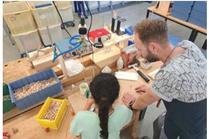
Laurin Dill hilft beim Umgang mit der elektrischen Leimspritze. Diese wird nämlich mit einem Fußhebel bedient.
