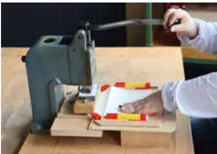
Der Prägestempel wurde in die Kniehebelpresse montiert. Die Legosteine fixieren dem Briefumschlag.
